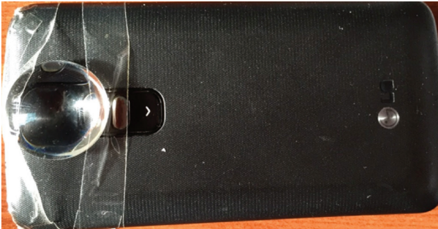
Resim 1. Doksan diyoptri temassız çift asferik lens akıllı telefona şeffaf bant ile yapıştırıldı
